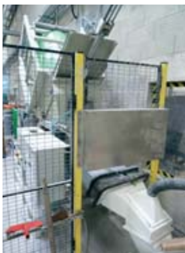
5. Le retourneur de fût (vert clair) passe et broie les brisures de tubes pour les diriger vers la machine principale du processus de recyclage des tubes fluorescents.
