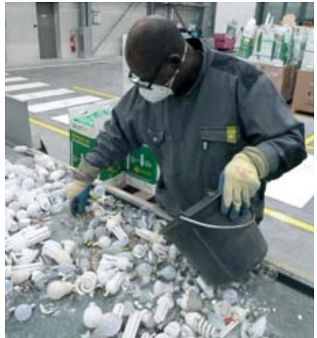
4. Étalage des petites ampoules pour un contrôle manuel qui retire les autres objets, placés dans le seau : piles, téléphones, etc.
